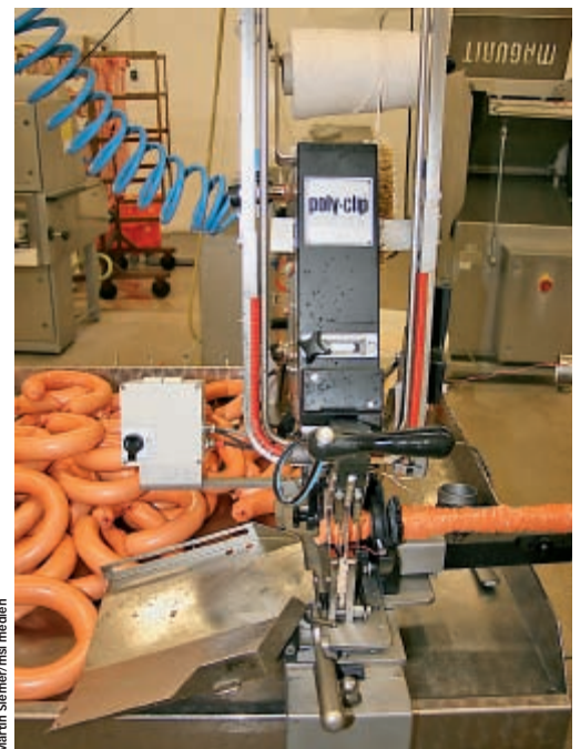
Der PDC 600 kann als Tischgerät oder auf einem verstellbaren Rollgestell genutzt werden.
