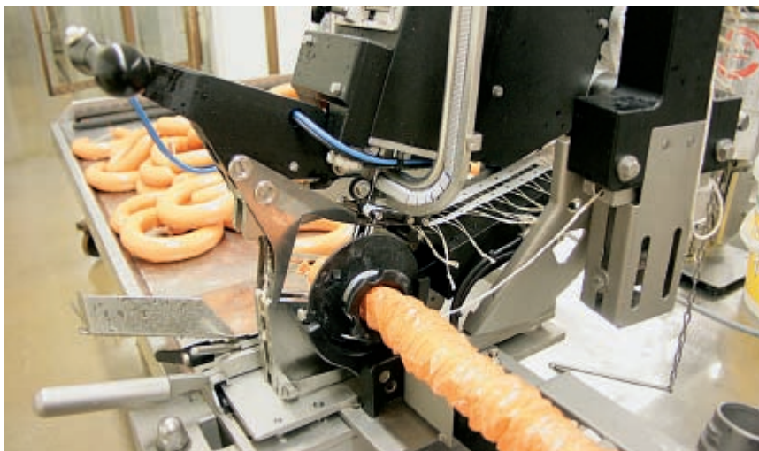
Der Doppel-Clip-Halbautomat PDC 600 spielt gerade bei kleinen Kalibern seine Stärken aus.
