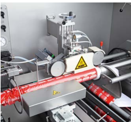
Heißsiegelstation des TSCA für zuverlässige Siegelung
