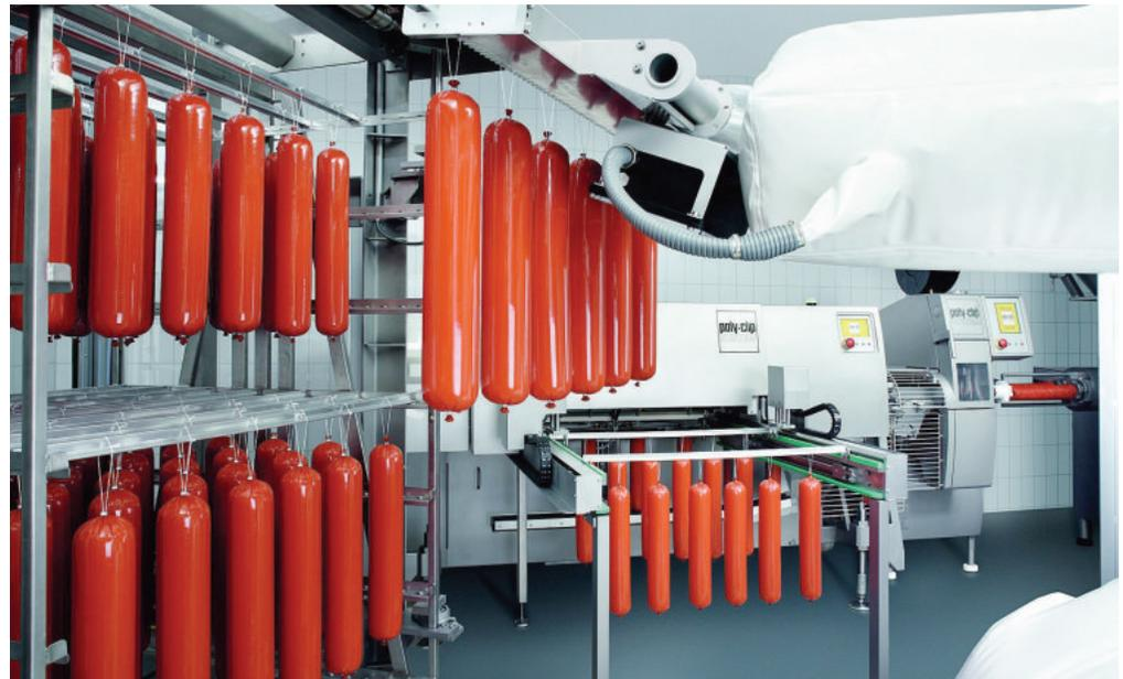
Abb. 1: Der Roboter Typ ASL-R wird zur Rauchwagenbeladung eingesetzt, die automatische Aufhängelinie Typ AHL schafft deutliche Entlastung.
