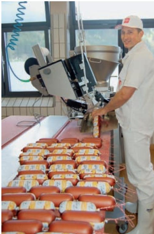
Der Doppel-Clip-Halbbautomat ist ideal geeignet zum Verschließen von Därmen aller Art bis Kalibergröße 80 Millimeter.
