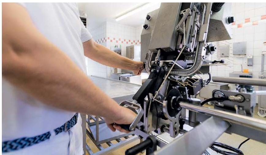
Zu den Neuerungen beim neuen Modell des PDC 700 gehört unter anderem eine Zweihandauslösung des ersten Clips.
