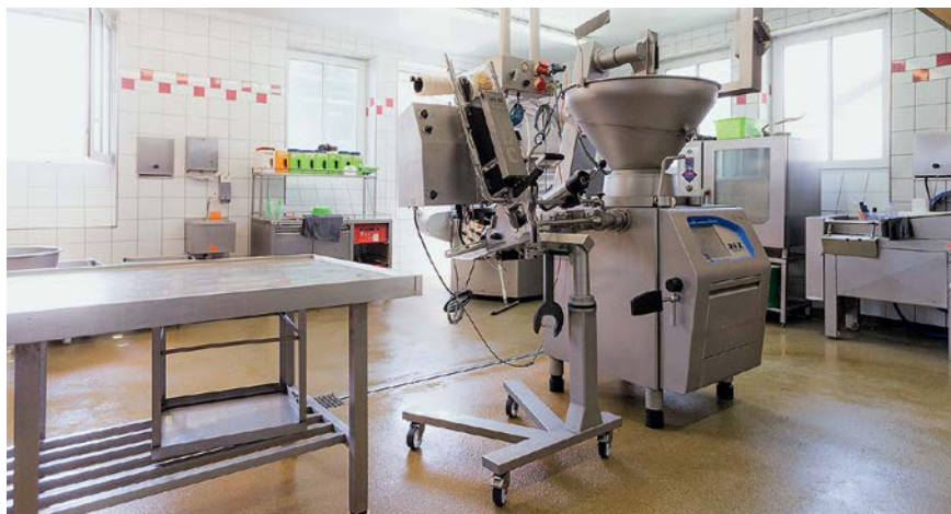
Der Doppelclip-Halbbautomat eignet sich für alle Kunststoff-, Kollagen-, Faser- und Naturdärme und für Produkte mit Kalibern von bis zu 115 mm.
