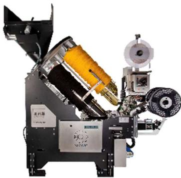
Der neue Netclipper CGC von Poly-clip System, entwickelt in Zusammenarbeit mit Damarc Agrobotic, ermöglicht den Einsatz biologisch abbaubarer und industriell kompostierbarer Bio-Clips.
